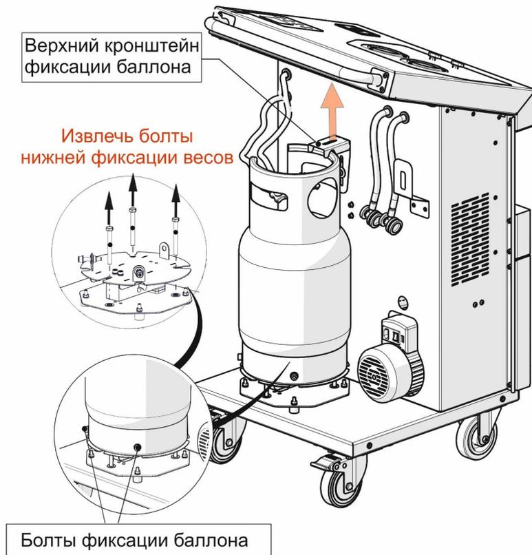
Рис. 5 Фиксация внутреннего баллона
