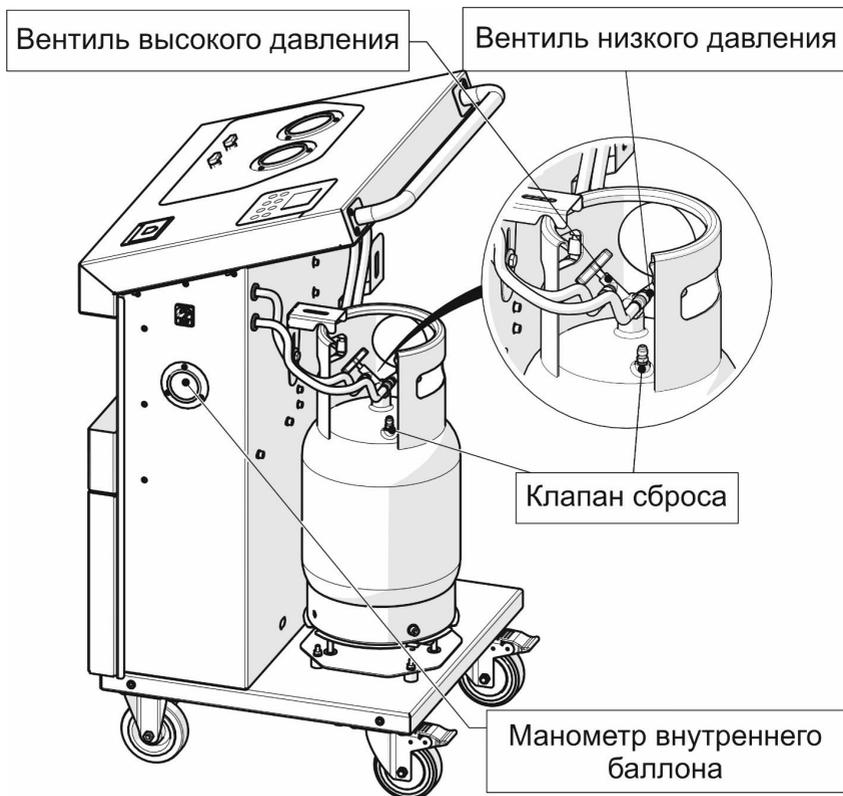
Рис. 7 Сброс неконденсируемых газов.
