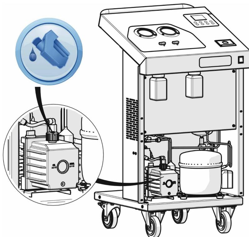
Рис. 9 Заправка вакуумного насоса.
