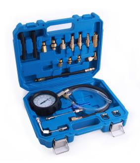
Используя входящие в комплект штуцера, трубки, адаптеры можно подключаться в разные части топливной системы автомобиля для определения работоспособности бензонасоса, пропускной способности топливного фильтра, определения давления в топливной рампе и многие другие тесты позволяющие определить состояние топливной системы автомобиля. Рабочее давление 1-10 Бар.
