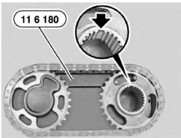
Специальный шаблон используется при замене распределительного вала на двигателях BMW M52TU, M54 и M56 с двойной системой VANOS. С помощью данного приспособления выполняется установка зубчатых колес на распределительные валы. Зубчатые колеса вкладывают в шаблон строго как показано на рисунке, далее вместе с шаблоном устанавливаются таким образом, чтобы разрыв между шлицами на валу и звездочки находились друг напротив друга.
